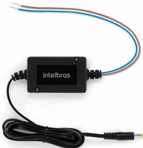
A EF 1201+ é uma fonte de alimentação AC/DC de 12 V multiuso, projetada para instalação em caixas 4"x2" e ideal para alimentar câmeras e sistemas de CFTV, fitas de iluminação LED, sistemas de controle de acesso e automação, roteadores, entre outras aplicações. Com corrente de até 1 A, pode alimentar até 4 câmeras HD<sup>1</sup>.
